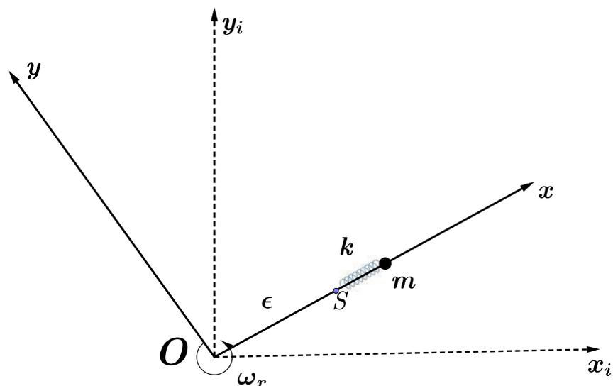
Figure 1: Nel piano orizzontale sono mostrati il sistema di assi non rotanti  $Ox_i y_i$  e la piattaforma rotante  $Oxy$  sulla quale si può muovere senza attrito il corpo puntiforme di massa  $m$  collegato con una molla di lunghezza a riposo nulla e costante elastica  $k$  al punto di sospensione  $S$  fissato sul piano rotante
