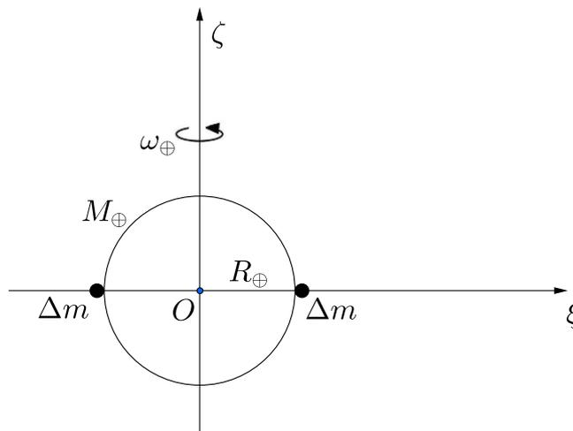
Figure 1: L'eccesso di massa equatoriale della Terra dovuto alla sua rotazione a velocità angolare  $\omega_{\oplus}$  attorno all'asse  $\zeta$  può essere rappresentato come un anello. Noi lo semplifichiamo ulteriormente considerando un piano meridiano (il piano  $\xi, \zeta$ ) e rappresentando l'eccesso di massa con i due punti massa  $\Delta m$ . Si assume  $\Delta m \ll M_{\oplus}$  perciò  $M_{\oplus}$  è la massa totale della Terra;  $R_{\oplus}$  è il suo raggio medio
