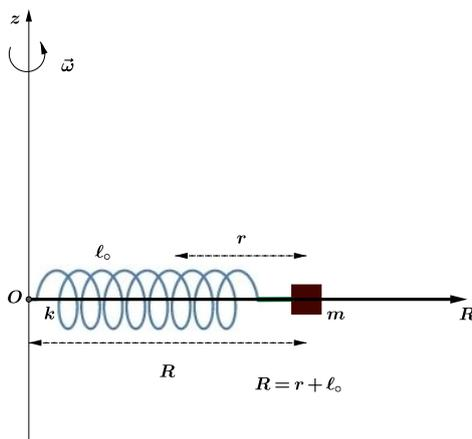
Figura 1: Il cubetto di massa  $m$  può scorrere (senza attrito) lungo un'asta diretta come l'asse orizzontale  $R$  mentre è collegato alla sua origine con una molla di massa trascurabile e costante elastica  $k$ . A sua volta l'asta ruota attorno all'asse verticale  $z$  con velocità angolare costante  $\vec{\omega}$ .
