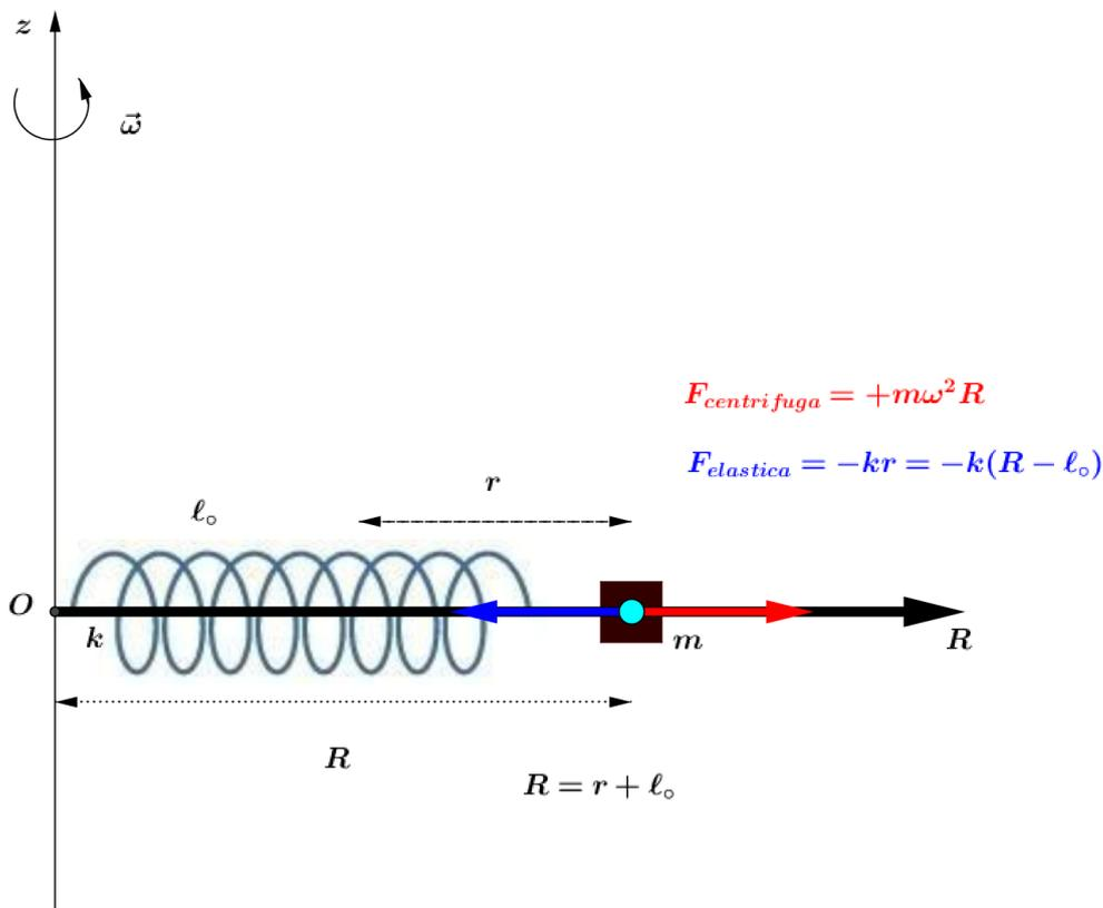
Figura 2: Come la Fig. 1 con aggiunta delle forze in gioco lungo l'asse  $R$ , che sono state disegnate nel caso particolare in cui sono uguali in modulo. Ne deriva che la posizione del cubetto indica quella all'equilibrio come calcolata al punto 2.
