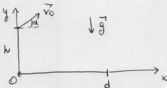
$$\begin{cases} x(t) = v_0 \cos \alpha t \\ y(t) = h + v_0 \sin \alpha t - \frac{1}{2} g t^2 \end{cases} \quad (1)$$
