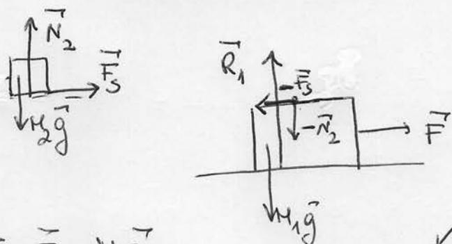
$$\begin{cases} \vec{N}_2 + H_2 \vec{g} + \vec{F}_S = H_2 \vec{a}_2 \\ \vec{F} - \vec{F}_S + \vec{R}_1 + H_1 \vec{g} - \vec{N}_2 = H_1 \vec{a}_1 \end{cases} \quad \begin{array}{l} \text{acc. di trascin.} \\ \vec{a}_2 = \vec{a}_1 + \vec{a}'_2 \quad \text{acc. relativa} \\ = 0 \Rightarrow \\ \vec{a}_1 = \vec{a}_2 \end{array}$$
