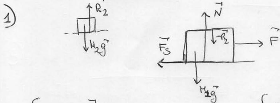
$$\begin{cases} H_2 \vec{g} + \vec{R}_2 = 0 \\ H_1 \vec{g} + \vec{N} - \vec{R}_2 + \vec{F} + \vec{F}_S = 0 \end{cases} \quad \begin{cases} -H_2 g + R_2 = 0 & R_2 = H_2 g \\ -H_1 g + N - R_2 = 0 & N = (H_1 + H_2) g \\ F - F_S = 0 & F = F_S \end{cases}$$
