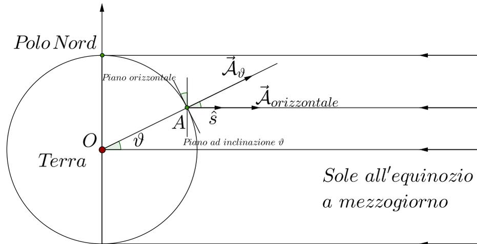
Figure 2: Replica della Fig. 1 dove si mostrano (in sezione) un pannello disposto sul piano orizzontale ed uno disposto in modo ottimale per la latitudine  $\vartheta$  dell'Osservatore  $A$ , i corrispondenti vettori  $\vec{A}_{orizzontale}$  e  $\vec{A}_\vartheta$  e il versore  $\hat{s}$  dall' Osservatore al Sole.
