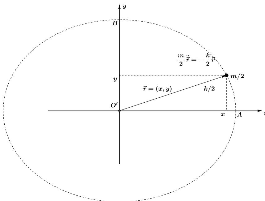
Figure 2: Il sistema di due masse dato e mostrato in Fig. 1 è stato ridotto ad un solo corpo di massa pari alla massa ridotta e raggio vettore della posizione istantanea  $\vec{r} = \vec{r}_2 - \vec{r}_1$ . La molla di costante elastica  $k/2$  (non disegnata in figura) va dall'origine  $O'$  alla massa ridotta. La traiettoria è una ellisse. Con le condizioni iniziali date gli assi maggiore e minore dell'ellisse sono gli assi coordinati.
