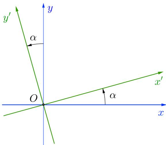
$$\begin{pmatrix} x' \\ y' \end{pmatrix} = \begin{pmatrix} \cos \alpha & \sin \alpha \\ -\sin \alpha & \cos \alpha \end{pmatrix} \begin{pmatrix} x \\ y \end{pmatrix}$$
