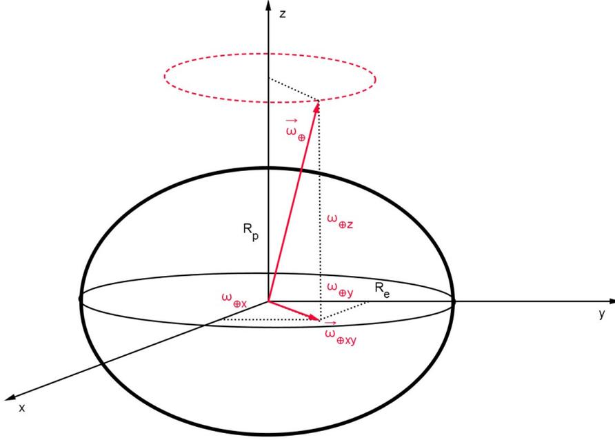
Figure 8: In prima approssimazione la terra può essere rappresentata come un corpo rigido a forma di sferoide oblato, cioè simmetrico attorno all'asse polare e con raggio equatoriale maggiore del raggio polare. È un fatto però che l'asse di rotazione diurna della Terra non coincide esattamente con il suo asse di simmetria, ma è leggermente inclinato rispetto ad esso. In figura questa inclinazione viene esagerata rispetto alla realtà per renderla evidente.
