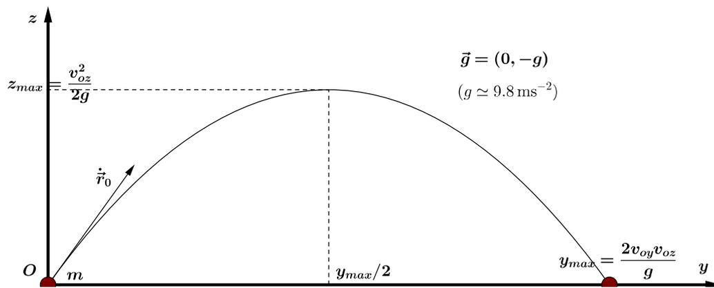
Figura 2: Traiettoria parabolica percorsa dal proiettile.
