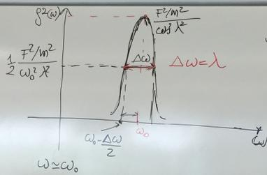
$\langle P \rangle = \frac{F^2/m^2}{[(\omega_0 + \omega)(\omega_0 - \omega)]^2 + \omega^2\lambda^2} \approx \frac{F^2/m^2}{4\omega_0^2(\omega - \omega_0)^2 + \omega_0^2\lambda^2}$   $\langle P \rangle(\omega_0) \approx \frac{F^2/m^2}{\omega_0^2\lambda^2}$
