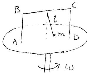
L'arco ABCD a cui è sospeso il pendolo è solidale al disco che ruota con velocità angolare costante  $\omega$ . Il pendolo può oscillare in un piano normale ad ABCD. Studiare le piccole oscillazioni.
